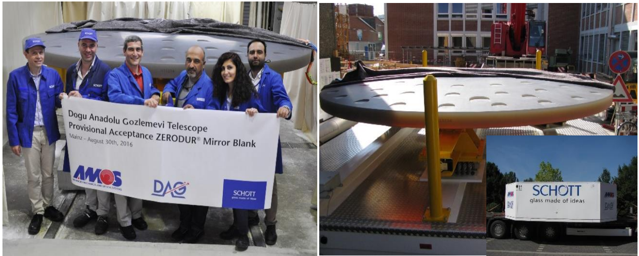
Şekil-8: 4 m çaplı DAG Teleskop Aynası ( Zerodur, Schott, Almanya, 2016 ).
