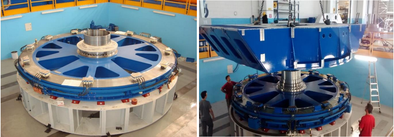
Şekil-12: DAG Teleskobu'nun fabrika kurulumu (Lecco/İtalya, 2017).
