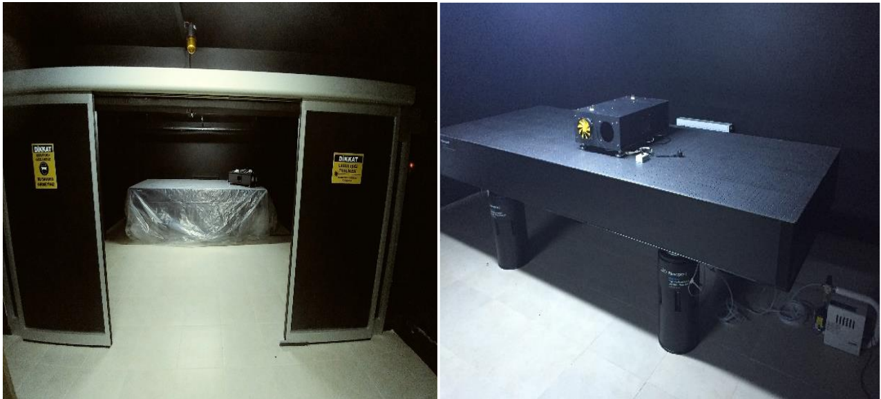
Şekil-14: DAG-OPAL kurulumu öncesi ATASAM binasında kurulan ön optik laboratuvar ve temel ekipmanlar (optik masa, türbülans jeneratörü, AO kiti).
