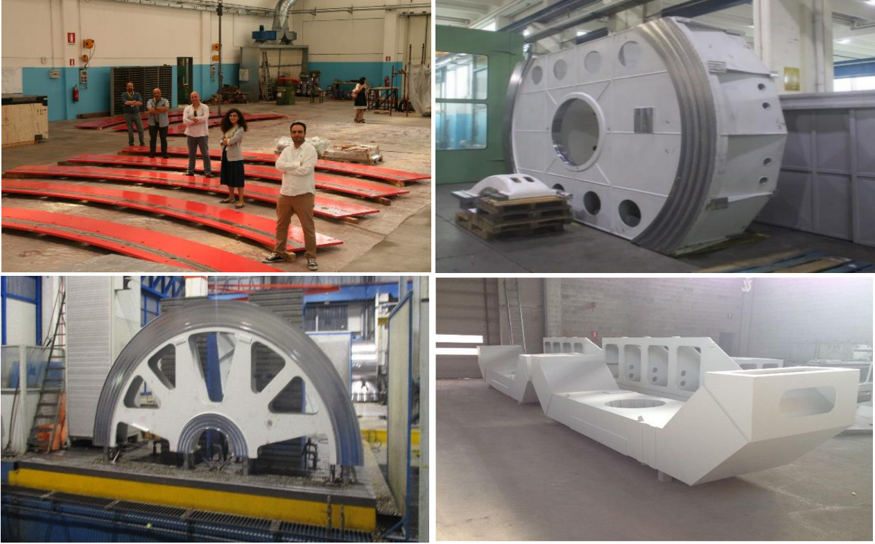
Şekil-10: DAG Teleskobu ve Kubbesi'nin mekanik aksamları (Lecco/İtalya, 2016).
