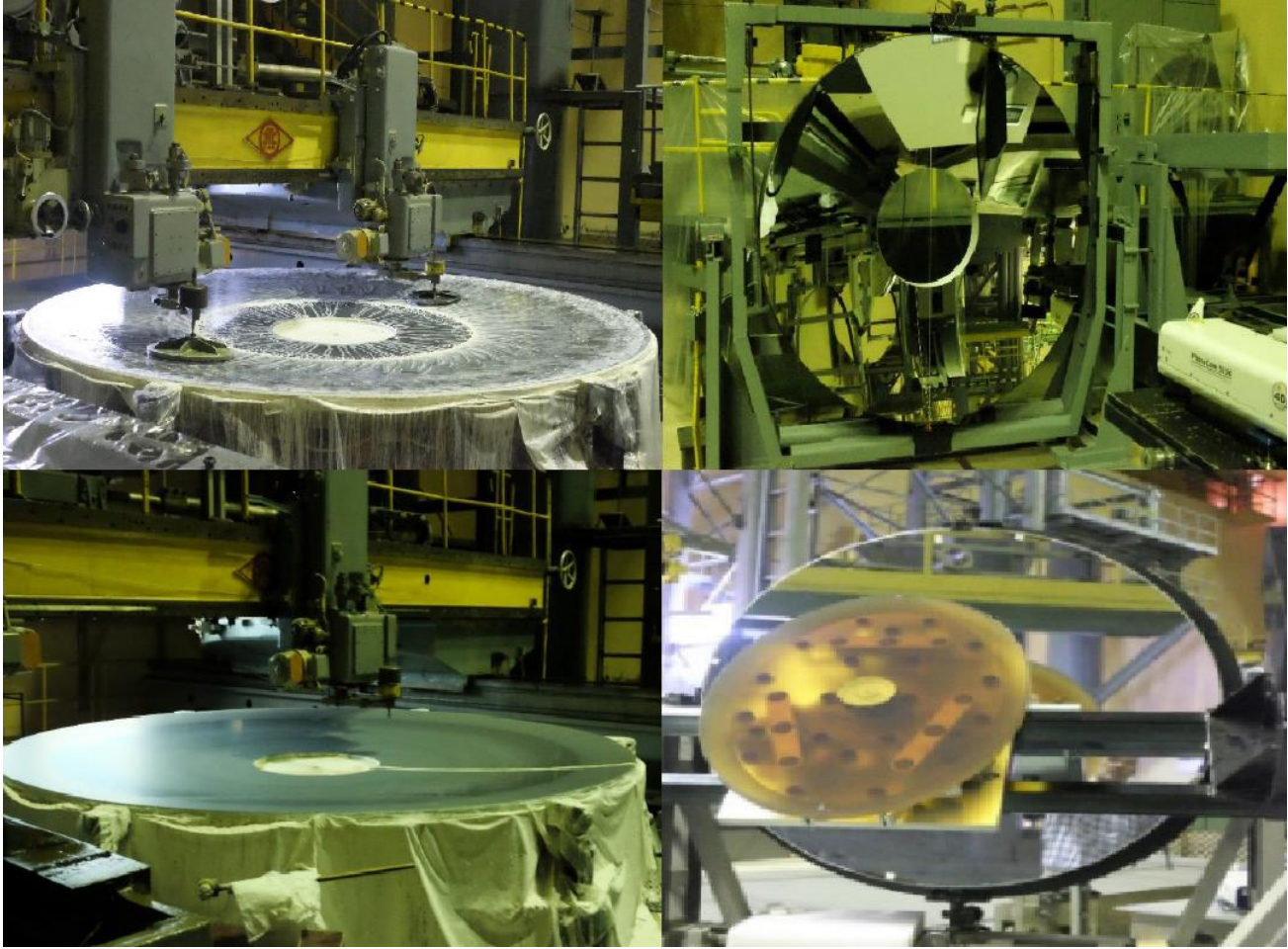
Şekil-8: DAG M1, M2, M3 Aynalarının traşlama - kaplama süreçleri (LZOS, Lytkarino/Rusya, 2017).
