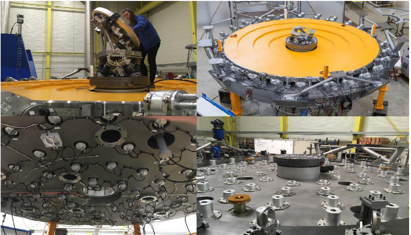
Şekil-7: DAG M1 Demo Aynası (4 m) üzerinde Aktif Optik sistemi Actuator montajı ve testleri ile M3 aynası Hexapod Sistemi montajı (Fabrika test alanı, Liege/Belçika, 2017 - 2018).
